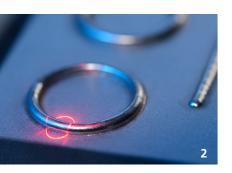
1. Messstrahlung (rot) zur Geometriemessung beim Laserauftragschweißen. 2. Inline-Messung von aufgetragenen Spurhöhen beim Laserauftragschweißen.
