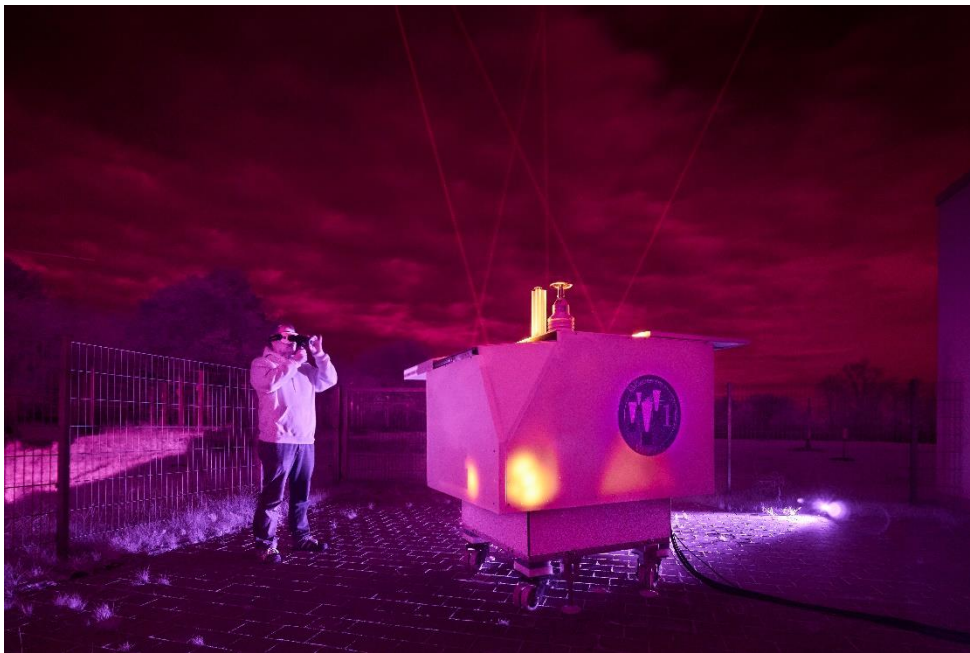
Bild 6: Das mobile LIDAR-System sendet fünf Strahlen in den Nachthimmel. Mit vier kleinen und einem großen Teleskop detektiert es die Photonen aus bis zu 100 km Höhe und liefert Klimadaten in Echtzeit. © Fraunhofer ILT, Aachen / Ralf Baumgarten.
