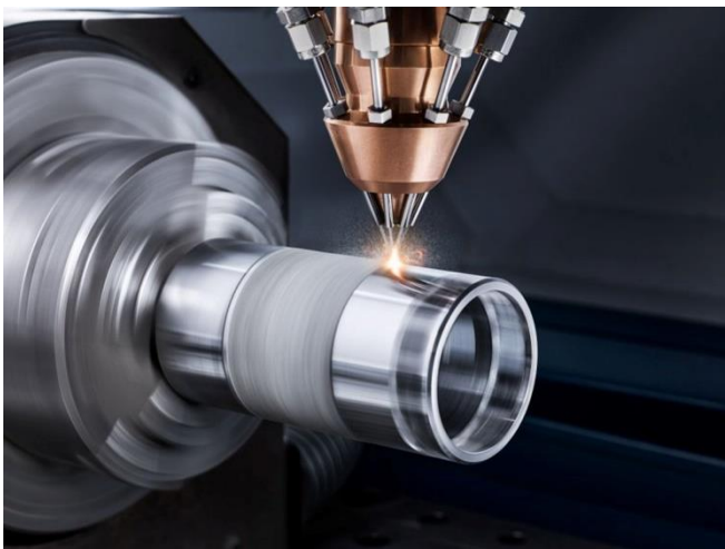
Bild 1: Extremes Hochgeschwindigkeits-Laserauftragschweißen EHLA mit innovativer TRUMPF-Systemtechnik. © TRUMPF GmbH + Co. KG (Holding), Ditzingen.
