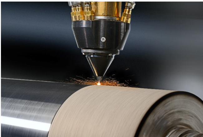
Bild 5: Beschichten einer Walze mit High-Power EHLA. © Fraunhofer ILT, Aachen.
