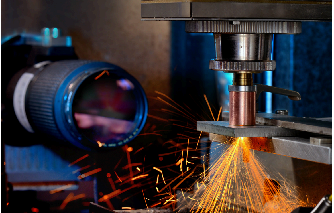
Laserstrahlschmelzschnitten mit der »Schneidpfeife«.
