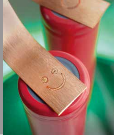
Laser-Based Tape-Automated Bonding (LaserTAB) zum Schweißen von Batteriezellen.
