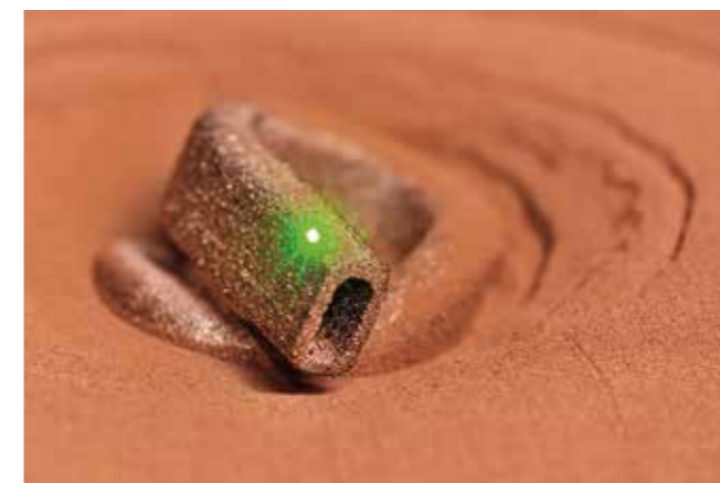
Bauteil aus Reinkupfer: Additiv gefertigt mit grünem Laser.
