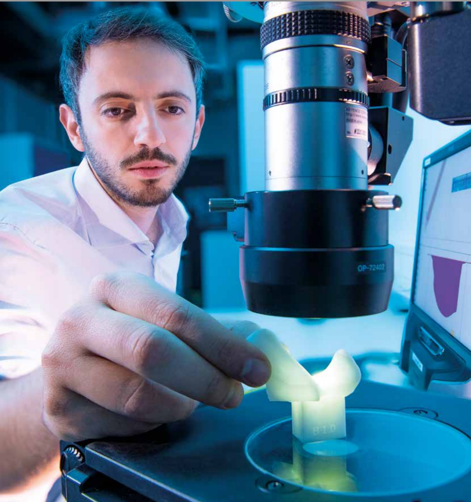
Optische Messungen an Knochenmodellen für die Laserchirurgie.
