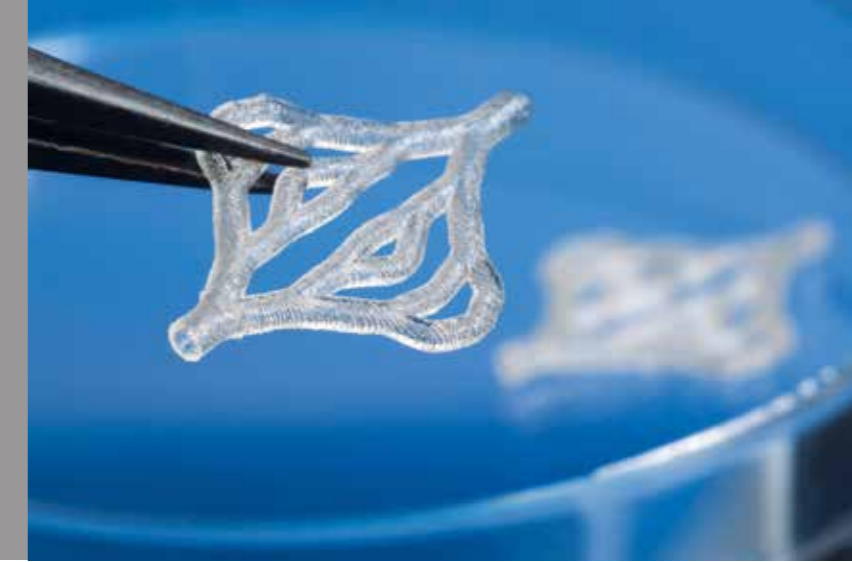
Verzweigte Mikroröhren ebenso wie komplette Mikrofluidiksysteme für die biomedizinische Analysetechnik.
