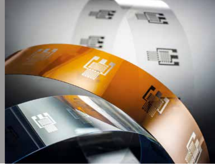
Gedruckte und laserfunktionalisierte Dehnungsmesssensoren auf Polymerfolien.
